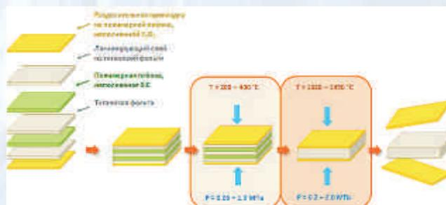
Схема получения керамического композита Ti<sub>3</sub>SiC<sub>2</sub>/SiC из многослойной непорошковой реакционной композиции Ti–SiC.
