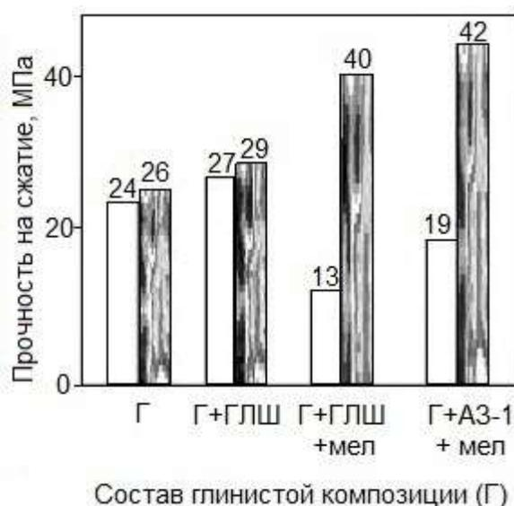
Рис. 3. Прочность на сжатие обожженных при 1000° С образцов из масс на Калининском суглинке (Г) с 20% композиционной добавкой при соотношении ГЛШ/мел=1, А3-1/мел=1:
