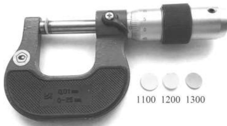
Рис.2. Образцы оксидной керамики LLT после спекания при температуре 1100-1300°C.
