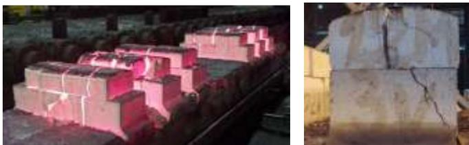
Рис. Фотографии разрушений огнеупорных блоков на телеге методической печи
