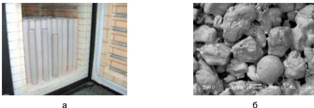
Рис. 1. Общий вид (а) и микроструктура (б) макропористой керамики из природного диоксида кремния.
