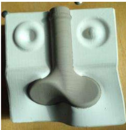
Рис. 3. Полуфабрикат мешалки в гипсовой форме
