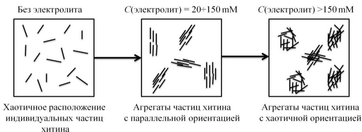
Рис. 14. Схематическое изображение ориентации частиц НКХ в растворах электролитов.
