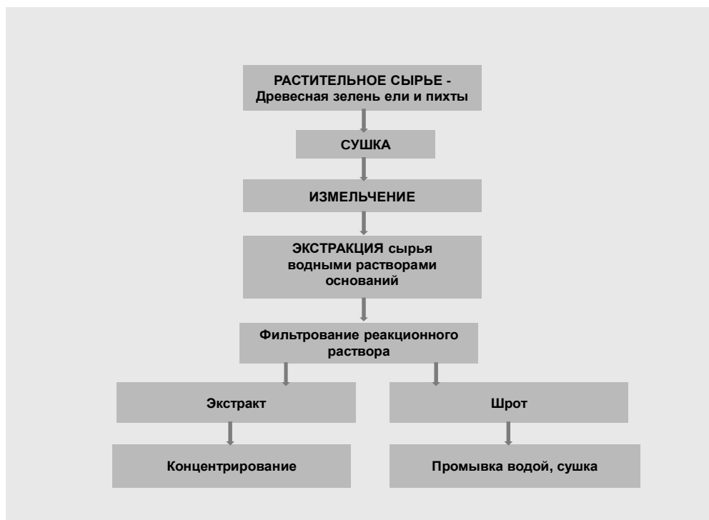
Рис.1. Схема выделения экстрактивных веществ древесной зелени
