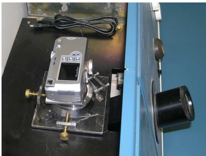
Рис. 2. Узел крепления фотоаппарата.
