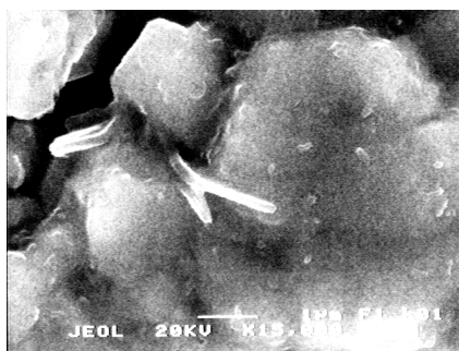
Рис. 1.1. Микрофотографии керамического композита, наполненного частицами гексаалюмината лантана и армированного нановолокном (микроскоп JSM – 6400, режим вторичных электронов).
